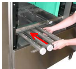
Überprüfen Sie ob alle Waschar-me richtig fest sitzen. Überprüfen Sie alle Waschar-me auf deren Vollständigkeit und richtige Position. Überprüfen Sie alle Waschar-mendkappen auf Dichtheit. Bauen Sie die Ablaufstand-rohre und Vorhänge wieder ein.
