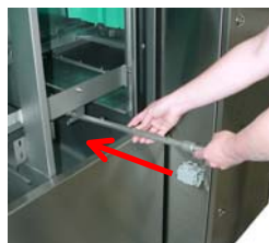
Überprüfen Sie ob alle Waschar-me richtig fest sitzen. Überprüfen Sie alle Waschar-me auf deren Vollständigkeit und richtige Position. Überprüfen Sie alle Waschar-mendkappen auf Dichtheit. Bauen Sie die Ablaufstand-rohre und Vorhänge wieder ein.
