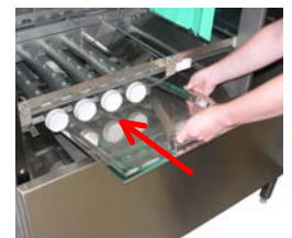
Nachdem Sie die Maschine gereinigt haben, bauen Sie alle Teile wieder ein, und prüfen Sie diese auf Vollständigkeit und richtige Position.
