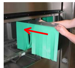
Überprüfen Sie ob alle Waschar-me richtig fest sitzen. Überprüfen Sie alle Waschar-me auf deren Vollständigkeit und richtige Position. Überprüfen Sie alle Waschar-mendkappen auf Dichtheit. Bauen Sie die Ablaufstand-rohre und Vorhänge wieder ein.
