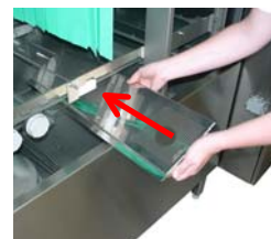
Nachdem Sie die Maschine gereinigt haben, bauen Sie alle Teile wieder ein, und prüfen Sie diese auf Vollständigkeit und richtige Position.
