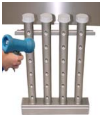
Reinigen Sie die Wasch- + Nachspülar-me und deren Düsen. Zum Reinigen der Düsen, benutzen Sie eine Nylon Bürste. Überprüfen Sie die Waschar-me und Endkappen auf Vollständigkeit und Dichtheit.
