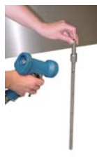
Reinigen Sie die Wasch- + Nachspülar-me und deren Düsen. Zum Reinigen der Düsen, benutzen Sie eine Nylon Bürste. Überprüfen Sie die Waschar-me und Endkappen auf Vollständigkeit und Dichtheit.
