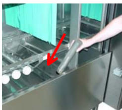
Überprüfen Sie ob alle Waschar-me richtig fest sitzen. Überprüfen Sie alle Waschar-me auf deren Vollständigkeit und richtige Position. Überprüfen Sie alle Waschar-mendkappen auf Dichtheit. Bauen Sie die Ablaufstand-rohre und Vorhänge wieder ein.
